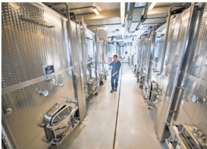
Le vigneron Basile Aymon dans la cuverie. Les cuves sont thermorégulées via une pompe à chaleur. PATRICK MARTIN
